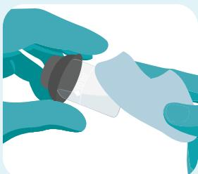
Mantenga limpio el instrumento. Seque todos los tubos antes de colocarlos en la célula óptica.
