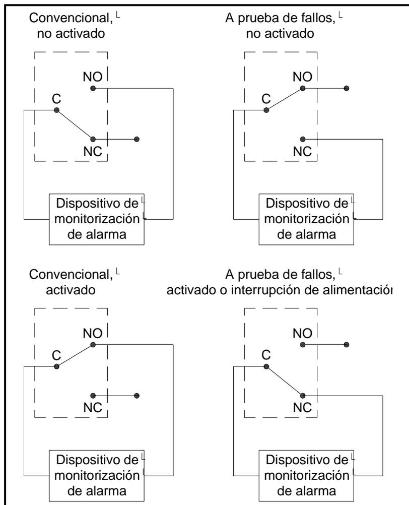
**Figura 1-4: Operación convencional y a prueba de fallos**
