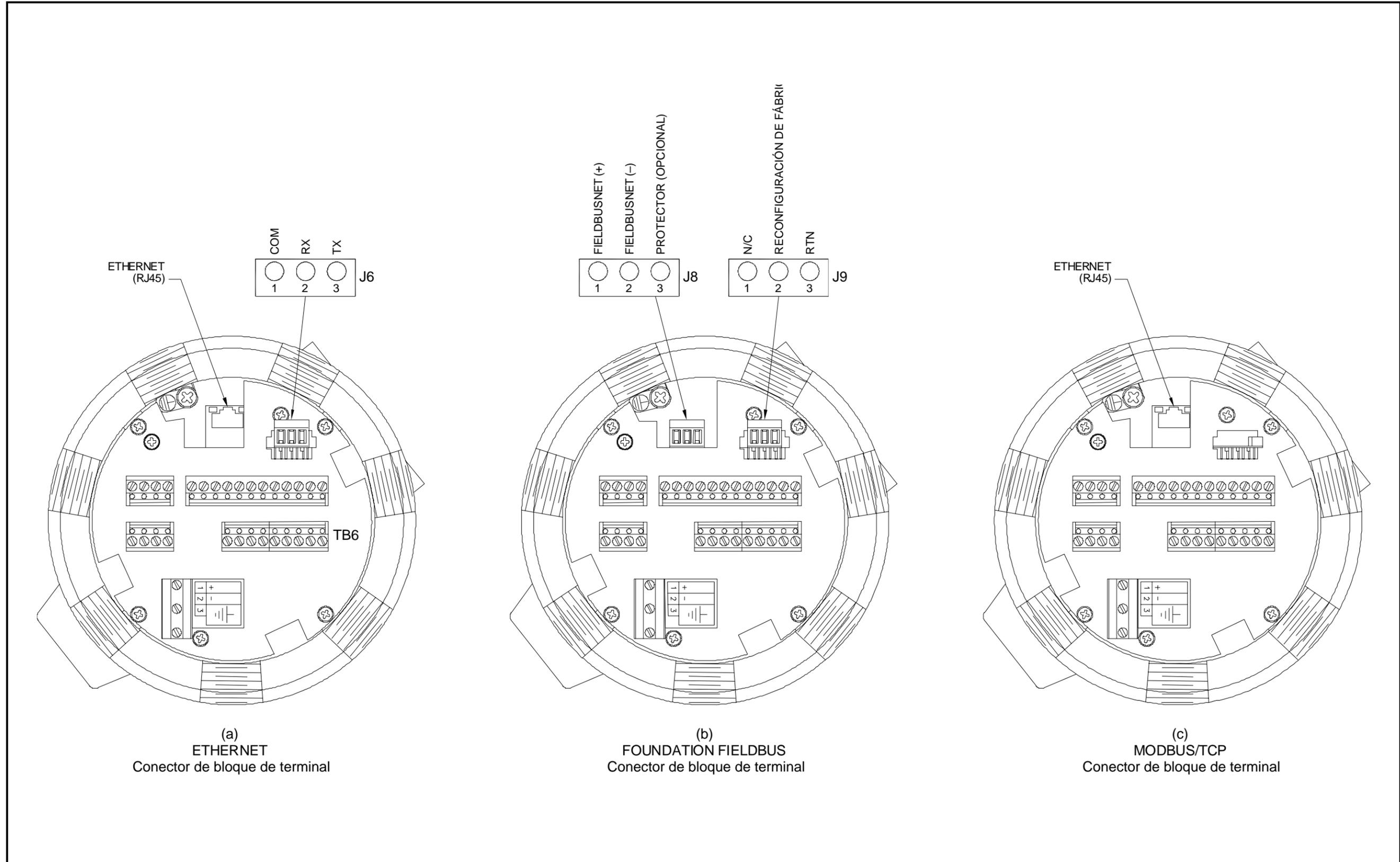
Figura 1-12: Conexiones de bloque de terminal de terminal de Ethernet, Foundation Fieldbus y MODBUS/TCP
