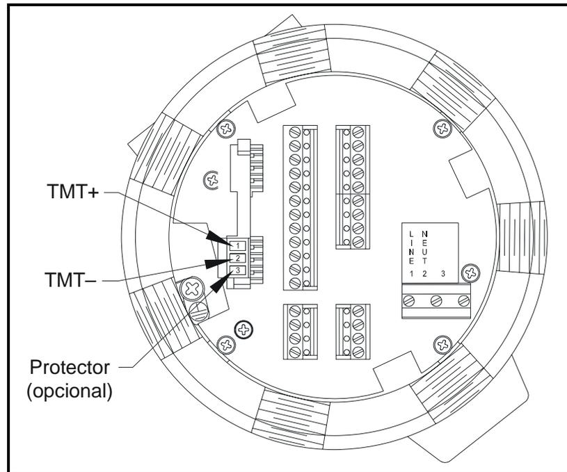
**Figura 1-7: Conexiones de bloque de terminal MODBUS**
