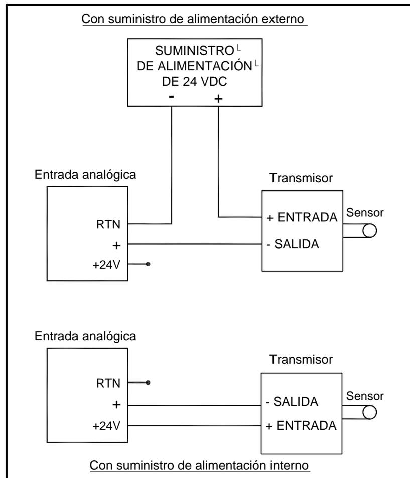
**Figura 1-5: Diagrama de cableado de entrada analógica**
