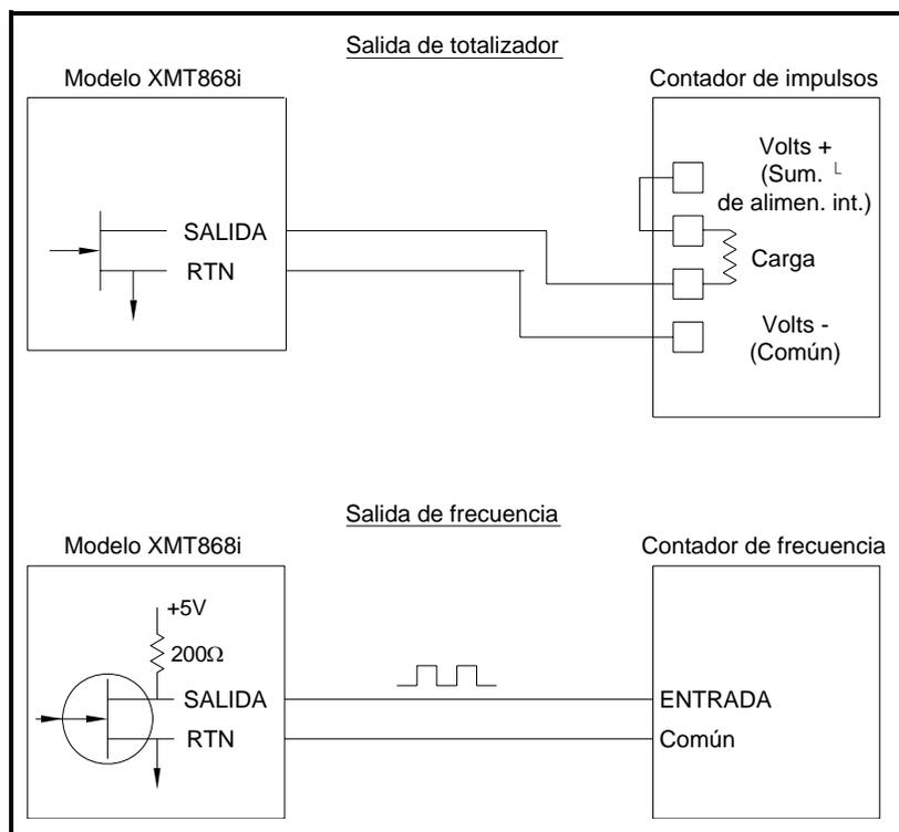
**Figura 1-6: Cableado de salidas de frecuencia y de totalizador**
