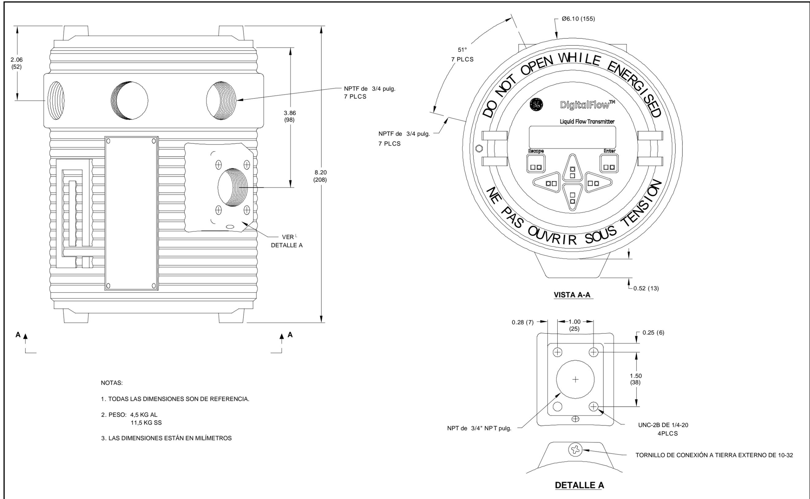
Figura 1-8: Esquema e instalación (ref. dibujo núm. 712-1318)
