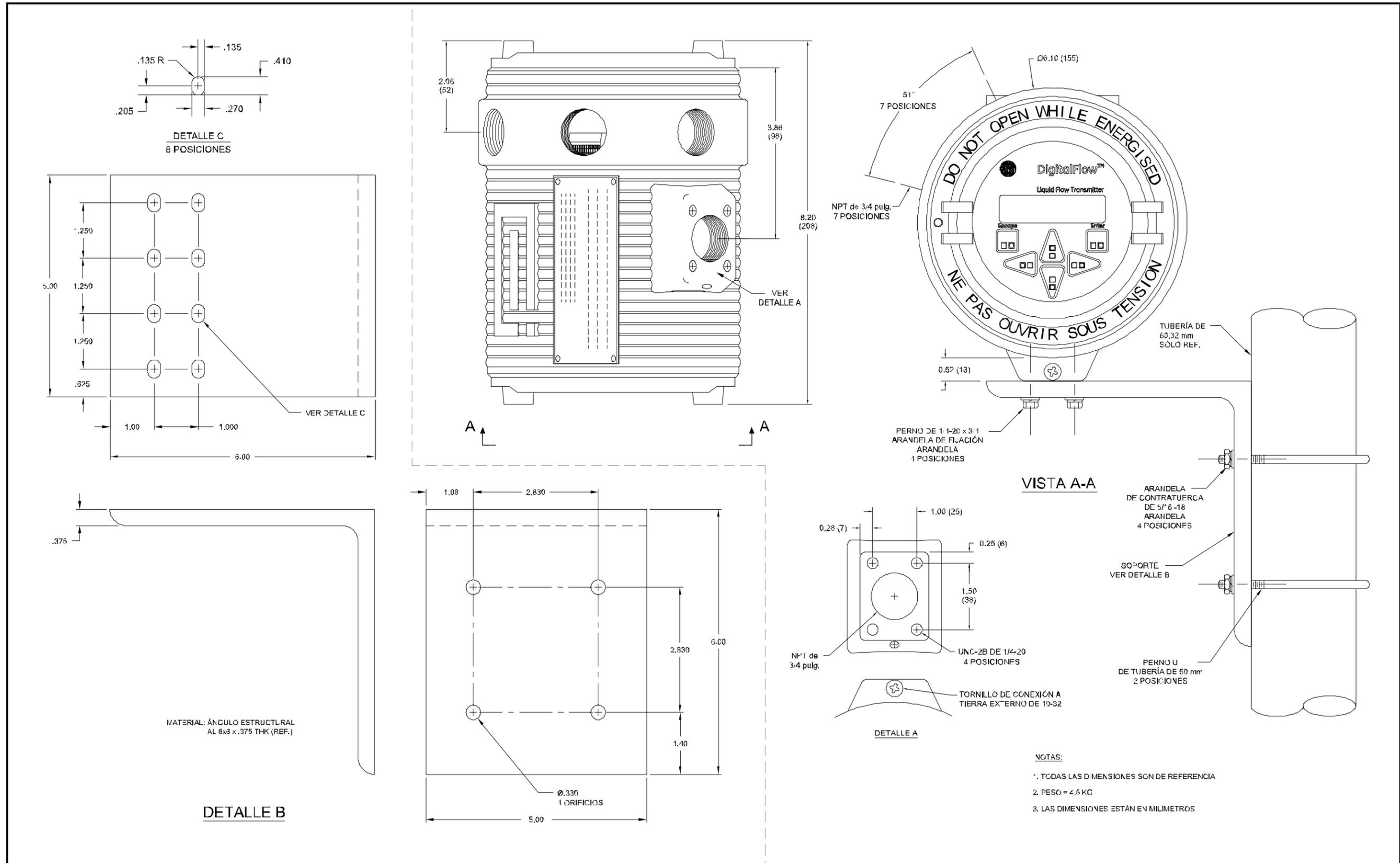
Figura 1-9: Esquema e instalación – Ángulo derecho del soporte de montaje (ref. dibujo núm. 712-1317)
