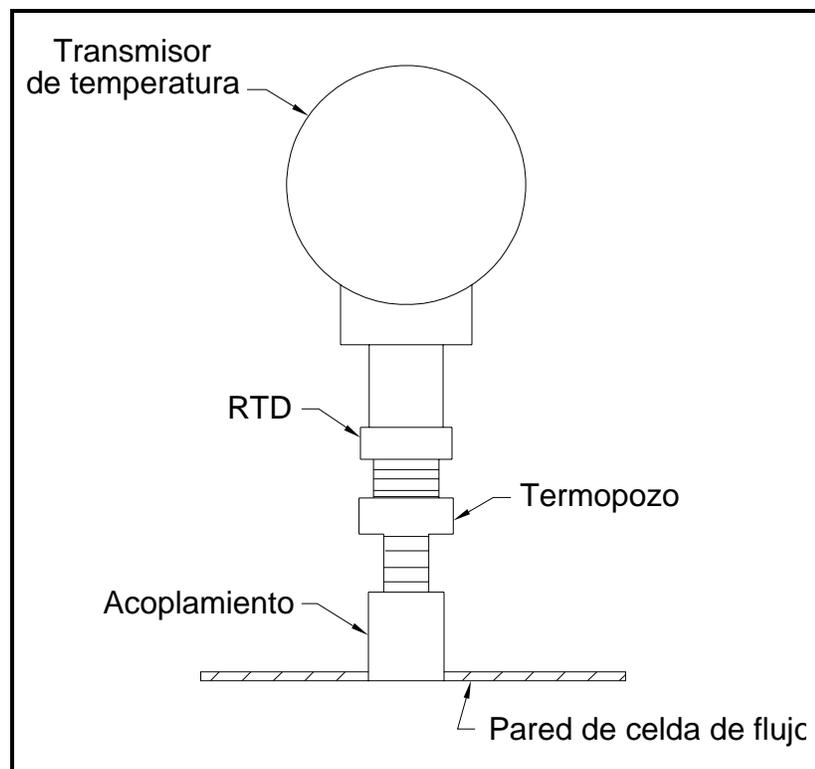
Figura 1-2: Montaje de transmisor de temperatura típico
