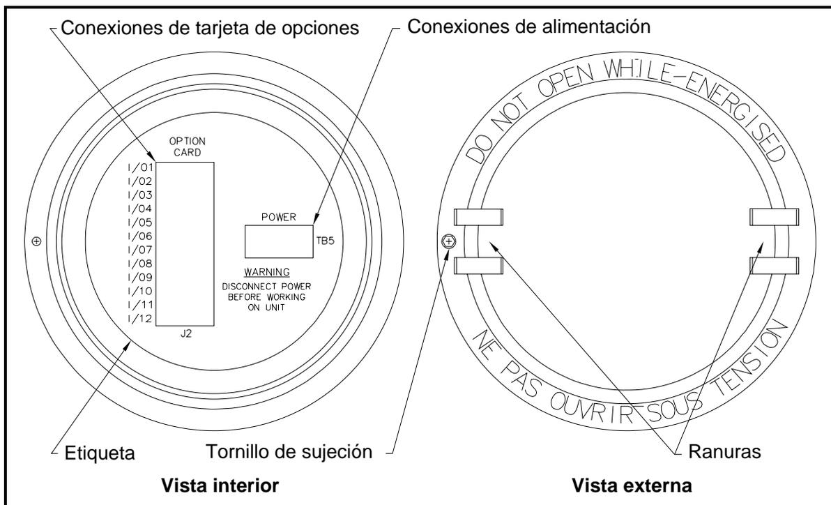
Figura 1-3: Cubierta posterior con etiquetas de conexión
