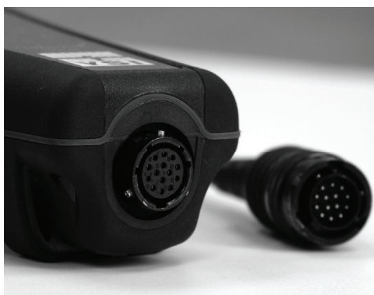
Figure 4, Notez le connecteur à clavettes.
