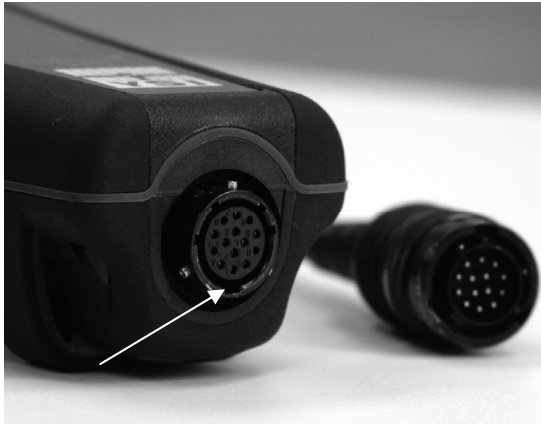
Abbildung 4, Auf die Schlitze im Kabelanschluss achten.
