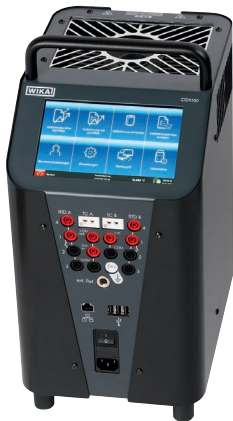
Temperatur-Blockkalibrator Typ CTD9350-165
