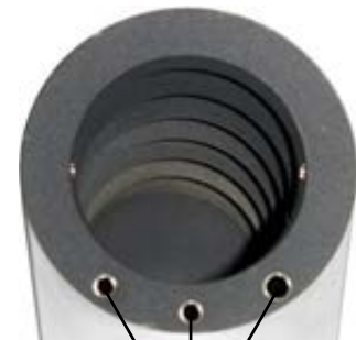
Bohrungen für externe Referenzfühler
