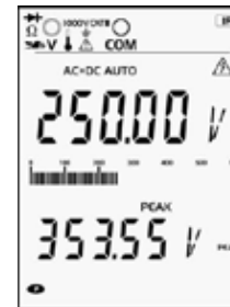
Modo PEAK Ejemplo de pantalla que muestra el valor + pico
