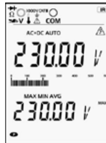
MAX/MIN AVG Muestra los valores máximo, mínimo y medio
