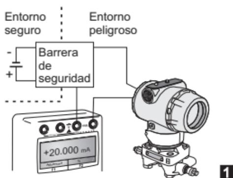
Medición de corriente en lazo cerrado desde el terminal de prueba del transmisor
