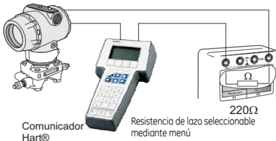
Esta aplicación permite utilizar los modos de medición y generación de mA a través de un comunicador Hart®.
