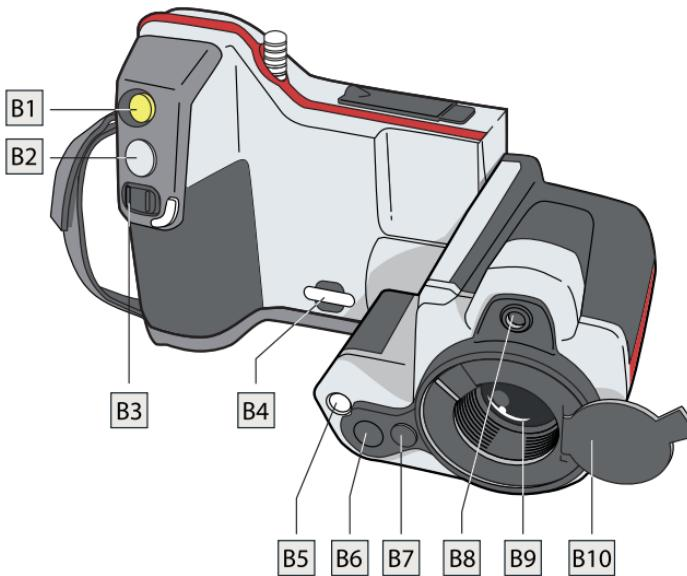
**B1.** Laserosoittimen näppäin: painamalla tätä voit aktivoida lasersoittimen.
