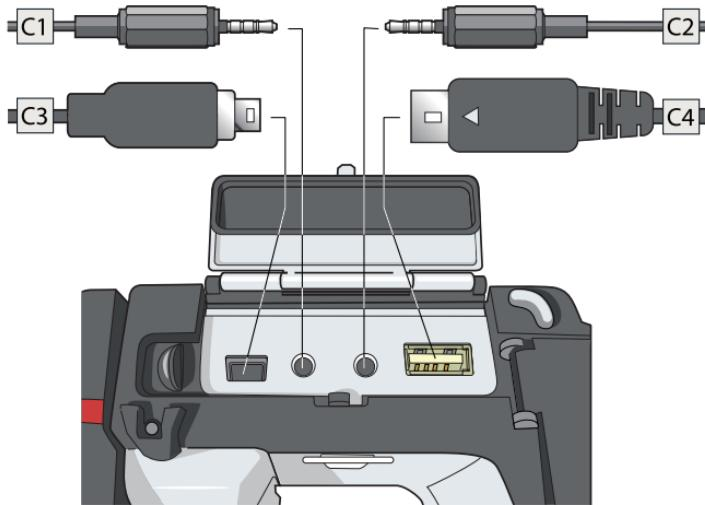
**C1.** 請使用耳機麥克風纜線與本插座，將耳機麥克風連接至熱像儀以錄製及收聽語音註解。
