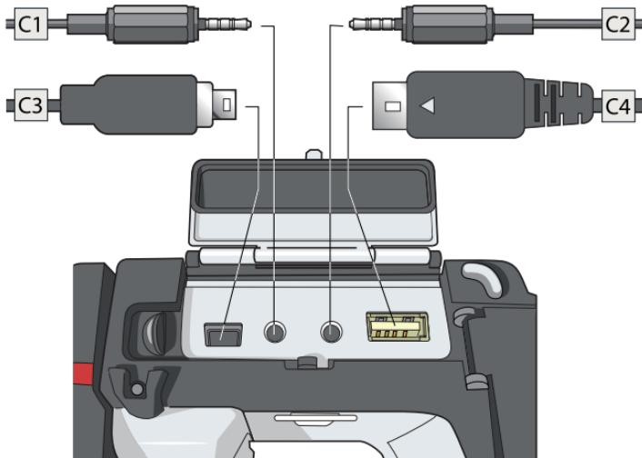
**C1.** Kytkemällä kuulokemikrofonin kaapelin kameran tähän liittimeen voit nauhoittaa ja kuunnella äänikomentteja.
