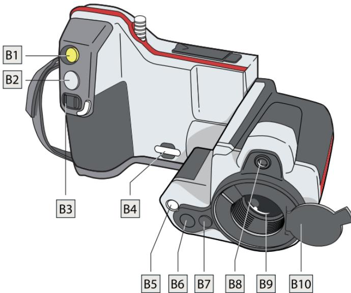
**B1.** Bouton Pointeur laser : permet d'activer le pointeur laser.
