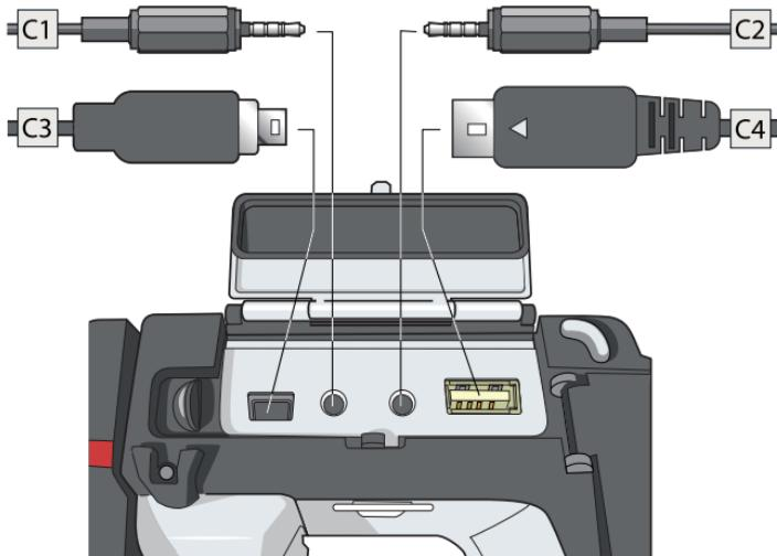
**C1.** Använd en headsetkabel och det här uttaget om du vill ansluta ett headset till kameran för att spela in och lyssna på röstkommentarer.
