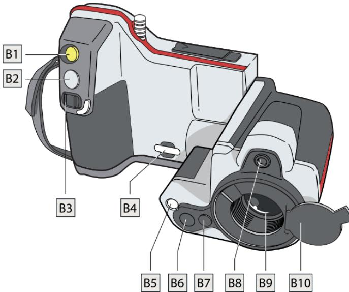
**B1.** 激光指示器按钮：按下可启动激光指示器。
