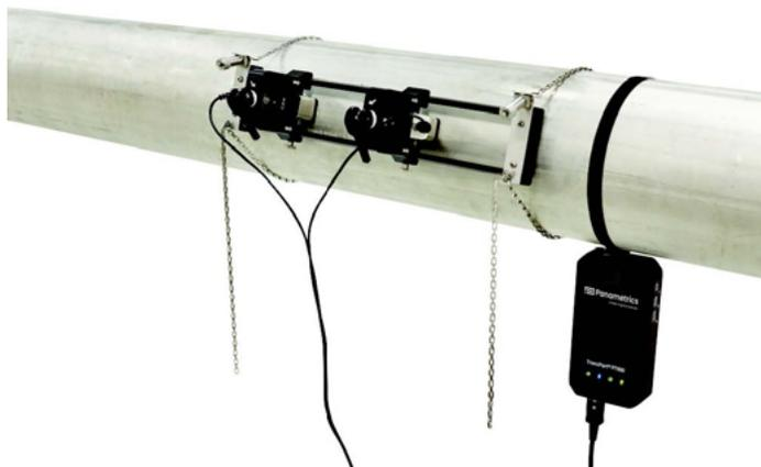
Accesorio de fijación, transductores y transmisor montados en la tubería
