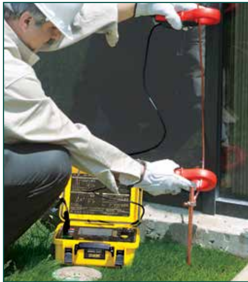
El modelo 6471 mide rápida y fácilmente el valor de la tierra usando el método de doble pinza (no se requieren picas auxiliares).
