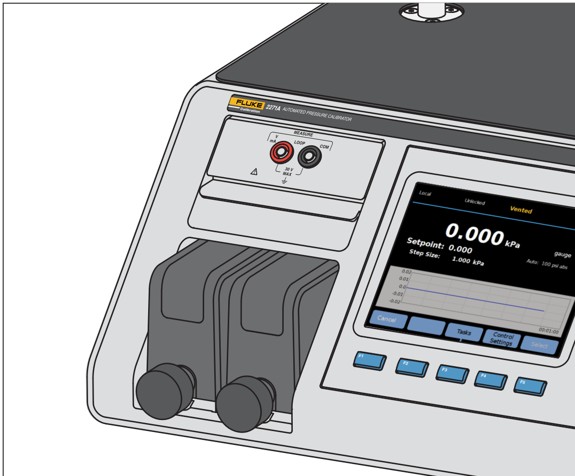
Figura 3. Módulos EMM y PMM instalados
